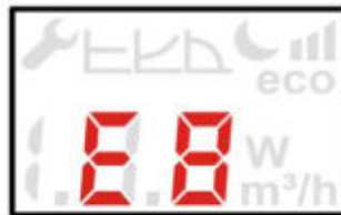
Abb. 15: Anzeige Fehlermeldung E8 (Motorfehler)
