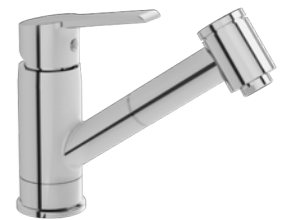
Spültisch-Einhandmischer schwenkbar, verchromt, Ausladung 180 mm, mit ausziehbarem Auslauf Art. Nr. GD61213
